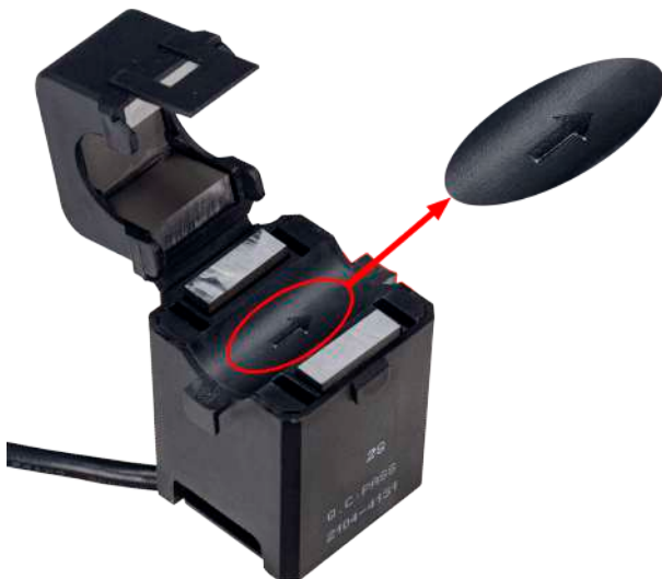
Рисунок 4. Указатель направления тока на датчике
